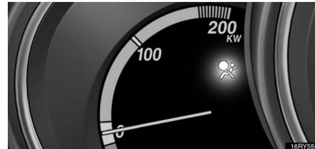
► SRS warning light
