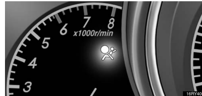
► SRS warning light
