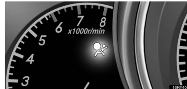
► SRS warning light
